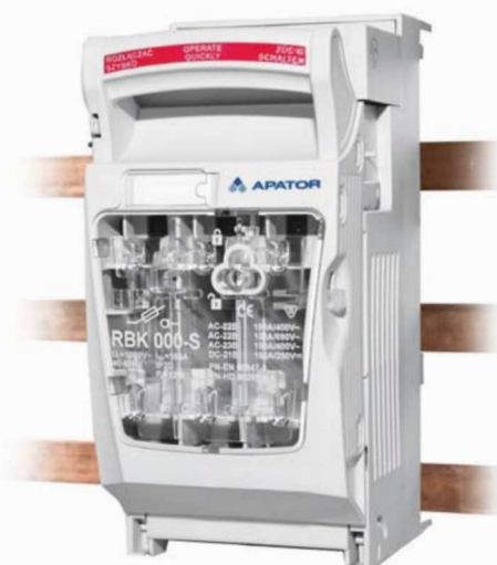
RBK 000-SG (odejście kablem z góry) RBK 000-SD (odejście kablem z dołu) wykonanie do montażu na szynach zbiorczych na rozstaw 60 mm
